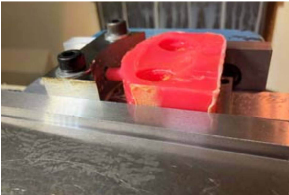
図 9 : 埋没材注入時に一時的にワークを取り外す
