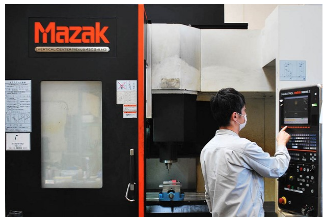
図 2：ヤマザキマザック社製 3 軸工作機械
